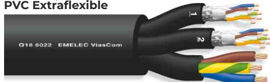
Q16-6024 4 x Cat.6 SF/UTP + Alim. 2,50 mm 2 PVC Extraflexible
